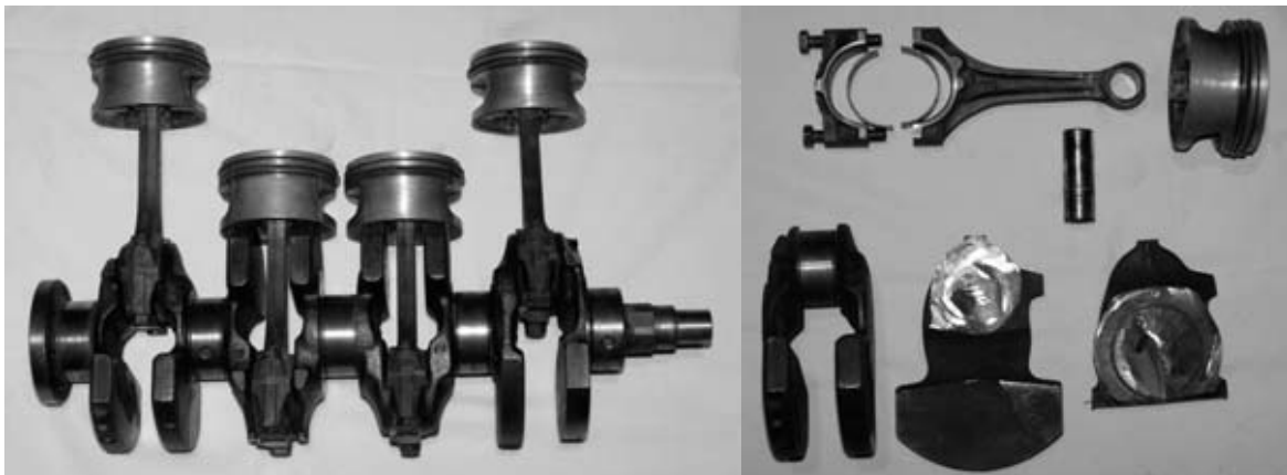
Rys. 6. Układ korbowo-tłokowy i jego elementy czterocylindrowego silnika OPEL CALIBRA 2.0 16V Fig. 6. Crank – shaft – piston arrangement and its parts of four cylinder's engine OPEL CALIBRA 2.0 16V
