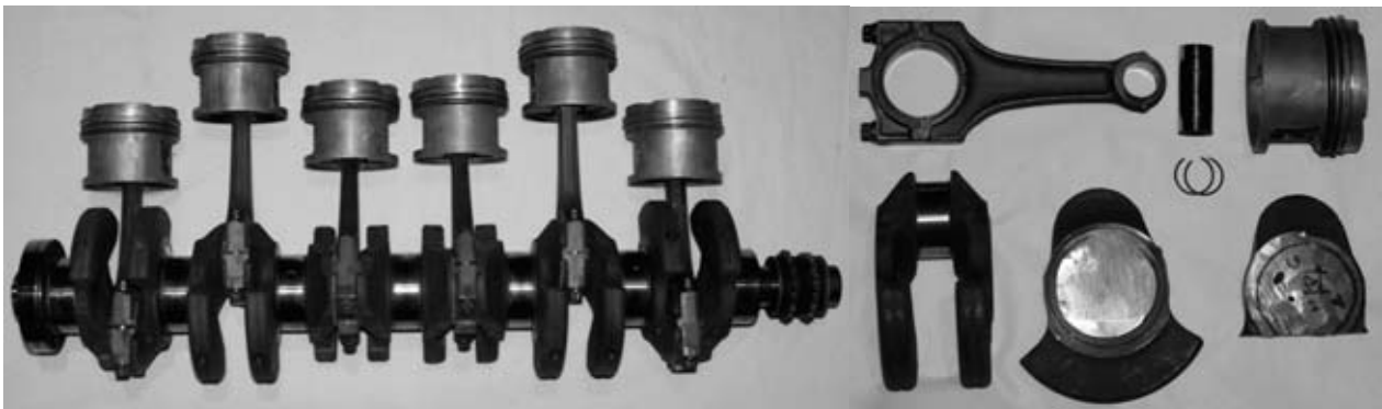
Rys. 3. Układ korbowo-tłokowy i jego elementy silnika sześciocylindrowego BMW E34 520i Fig. 3. Crank – shaft – piston arrangement and its parts of six cylinder's engine BMW E34 520i
